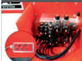
Afin de limiter le nombre de flexibles vers le tracteur, BIGAB propose une série de blocs hydrauliques pour le contrôle des différentes fonctions.
