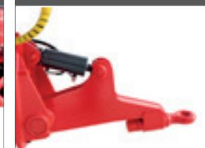
Nous pouvons fournir un timon avec suspension afin d'améliorer le confort de conduite. Ce dispositif permet d'absorber les secousses transmises par la remorque. Cet équipement est monté de série sur la BIGAB 22-27, mais il est également disponible en option sur la plupart des modèles.
