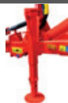
Trois types de béquilles sont disponibles. Une solution de base constituée d'une béquille rigide dotée d'orifices pour goupilles permettant de régler la hauteur lorsque le tracteur est équipé d'une barre de remorquage à levage ; une béquille hydraulique manœuvrée par un distributeur hydraulique simple effet ; une béquille réglable par manivelle pour les cas où il est nécessaire de régler la hauteur afin de l'adapter au véhicule de traction.
