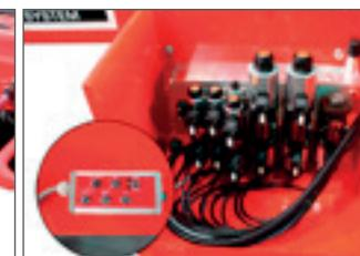
Soupape de commande électrique
