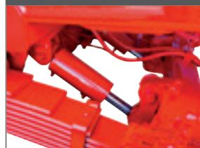
Plusieurs types de levage hydraulique de boggies existent pour la plupart des remorques. Cette fonction est appréciable lorsque vous roulez sur un terrain sensible et que vous devez effectuer un virage serré. Remarque : le levage de boggie ne peut être utilisé que lorsque la remorque n'est pas chargée.
