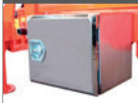
Afin de faciliter l'accès aux sangles d'arrimage, par exemple, ou autre matériel, il est possible d'équiper la remorque BIGAB d'une boîte à outils complète fixée sur le côté du châssis. Sur certains modèles, il est possible d'installer plusieurs boîtes à outils. Nous proposons des boîtes à outils peintes, en acier inoxydables et en plastique.
