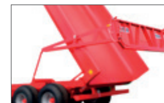
Mekaniskt tippkopplad bakläm (endast BT-8)
